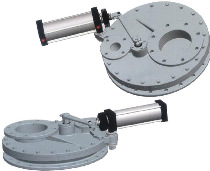
本阀主要适用于火电厂干灰系统灰、渣进料的启闭之用,也适用于矿山、石灰厂、水泥厂等有磨损、腐蚀的粉尘介质进料的启闭。本阀门具有密封性能好,耐高温,耐磨性强,启闭灵活,无卡灰及积灰现象,可节省一只排气阀,使用寿命长等特点。
