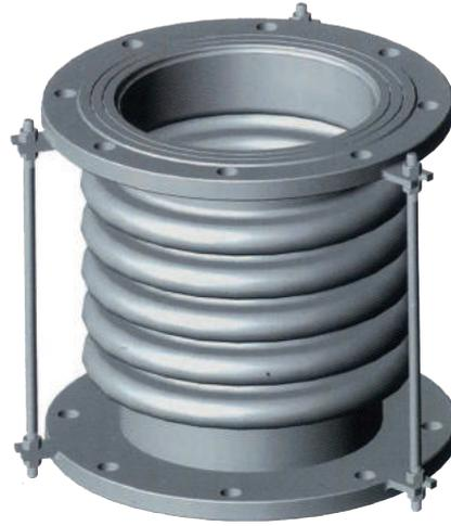
该膨胀节由一个波纹管和二一个结构件组成,它通过波纹管的柔性变形来吸收管线的轴向位移(同时也可吸收一部分横向位移),其两端与管道相连,为保证膨胀节在运输过程中波纹管刚性支承常安装有运输固定螺栓,产品在安装好以后拆除。
