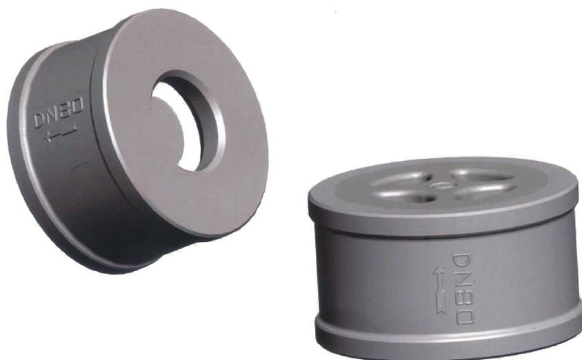
本阀主要适用于工业、环保、气物处理、高层建筑给排水管路等介质管路上, 阻止水、蒸汽、油品、污水、酸碱类等介质逆向流动之用。启闭件靠流动介质的力量自行开启或关闭。本阀门具有密封性能好, 启闭灵敏、耐高温, 耐磨性强, 设计合理, 体积小, 重量轻, 使用寿命长, 适用范围广。
